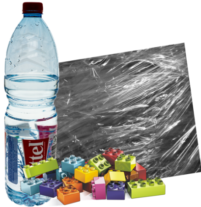
Alltagsbeispiele für Thermoplasten (Flasche), Duroplasten (Bausteine) und Elastomeren (Folie)
